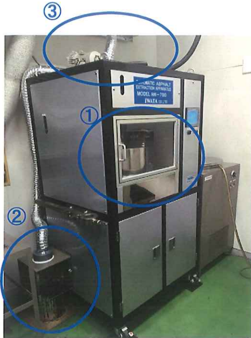
③ 装置上部で連結させダクト設備に排出
